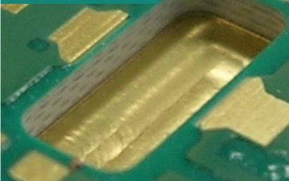
裏側の銅箔を表側から削り出すことにより、基板の放熱性が向上
