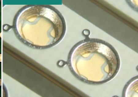
リフレクター部分を貼り合わせ。底面部分とリフレクター部分の表面処理は変更可能
