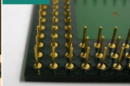
半田を用いずに、リードピンを基板に固定
