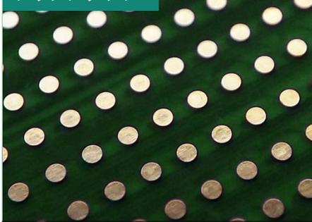
フリップチップ実装に対応した高密度基板を製造（ $\varnothing 0.1\text{mm}$ ・ $\varnothing 0.09\text{mm}$ 等）
